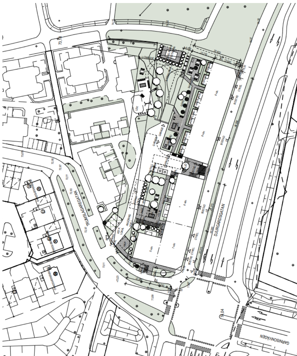
Illustrationsplan som visar hur bebyggelsen kan placeras inom planområdet och förslag på hur utemiljön och bostadsgårdarna kan gestaltas och disponeras. Källa: Reflex Arkitekter AB, 2022, på uppdrag av AB Stångåstaden.
