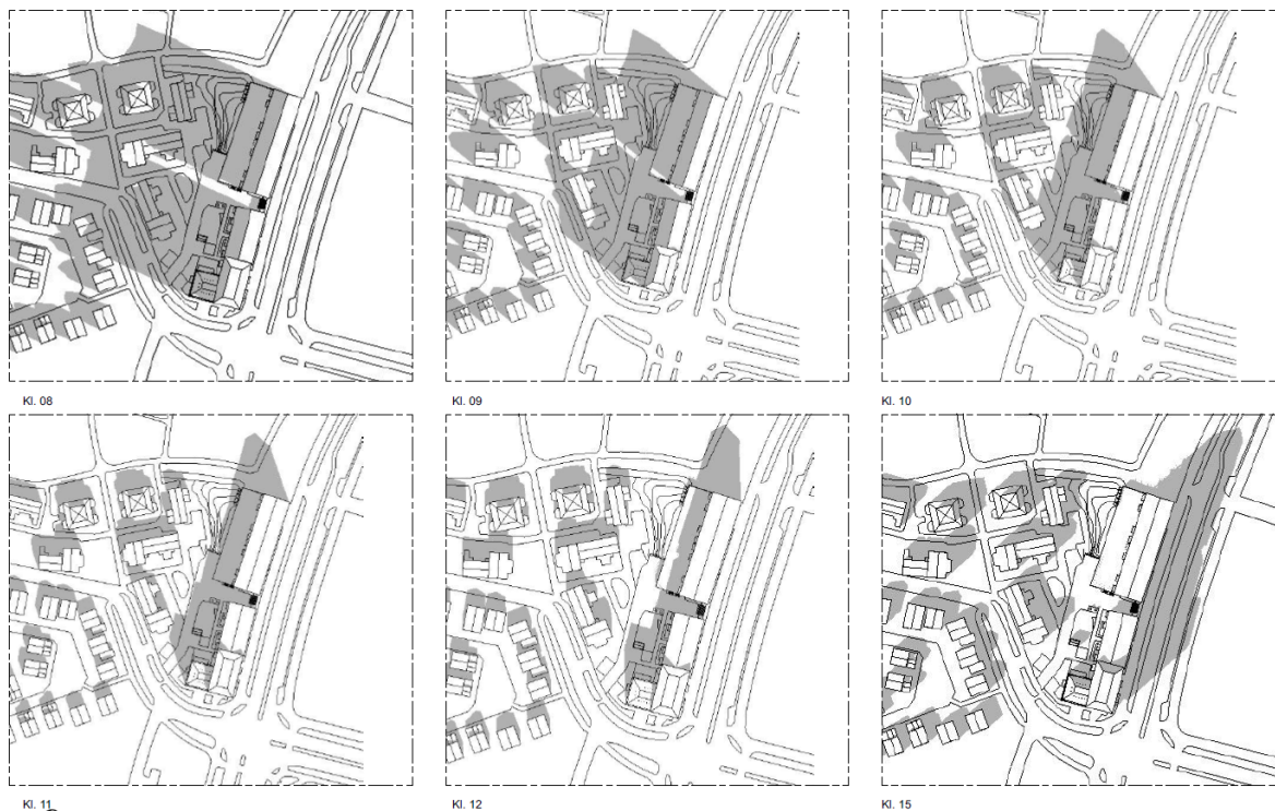
Illustrationen visar solstudie för nya och befintliga kvarter den 21 mars kl. 8, 9, 10, 11, 12 och 15. Källa: Reflex Arkitekter AB, 2021, på uppdrag av AB Stångåstaden.
