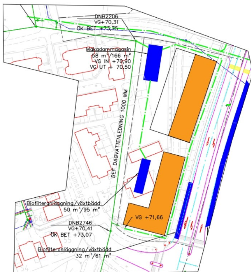
Karta från dagvattenutredningen som visar förslag på placering av nya ledningar (gröna streckade linjer) och dagvattenanläggningar (blå ytor).
